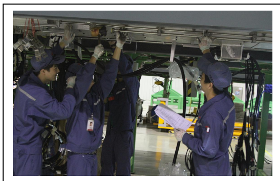
地铁车厢底部电线装配
